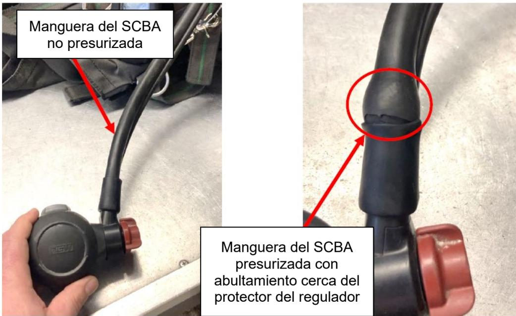
**Figura 1 - Ejemplo de manguera del regulador con abultamiento**
